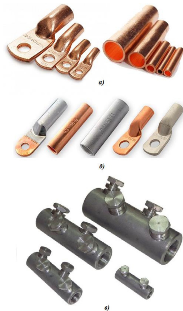
Рис. 100. Соединительные гильзы и наконечники: а) – медные наконечники и медные соединительные гильзы для пайки и опрессовки; б) – медные и алюминиевые гильзы и наконечники, закрепляемая опрессовкой; в) болтовые соединительные гильзы со срывной головкой
