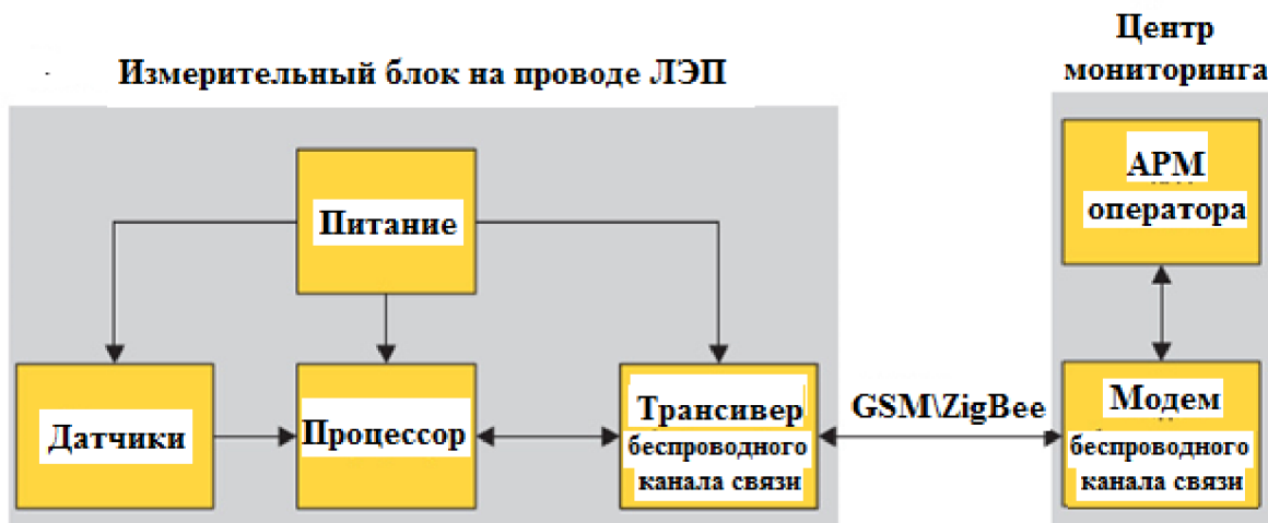
Рис. 37. Система мониторинга пропускной способности проводов ЛЭП
