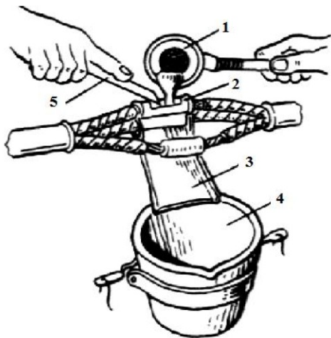
Рис. 103. Соединение жил пайки поливом расплавленного припоя: 1 – ложка паяльная; 2 – форма; 3 – лоток; 4 – тигель; 5 – скребок
