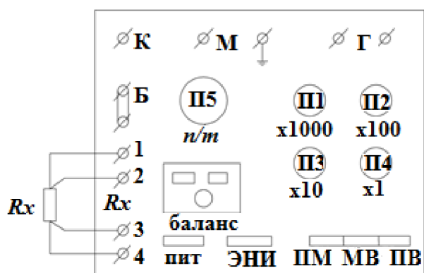
Рис. 57. Внешний вид верхней панели кабельного моста типа Р-333 при измерениях по четырехпроводной (измерение низкоомных сопротивлений) схеме
